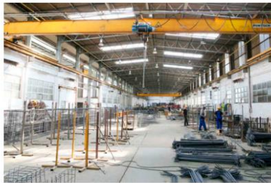
Die Eisenbiegerei: Dreßler fertigt die Bewehrungen für die Betonteile selbst an.
